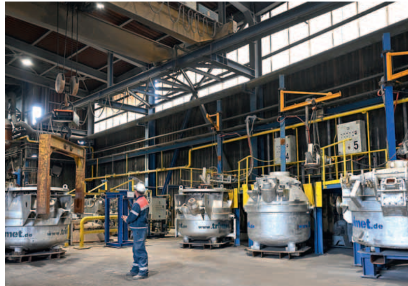
Trimet Aluminium wird ihr Recyclingwerk in Gelsenkirchen künftig mit wasserstoffreichem Kokereigas betreiben.
