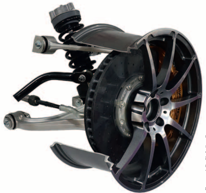
Abbildung 1: Bremsscheibentopf im Einbauszustand
